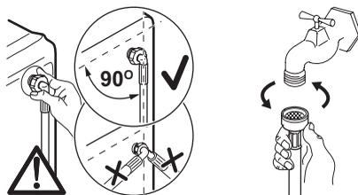
В случае необходимости передвиньте наливной шланг в направлении, показанном на рисунке. Для этого ослабьте зажимную гайку и расположите наливной шланг вниз, как показано на рисунке. Затяните зажимную гайку и проверьте соединение на отсутствие протечки.
