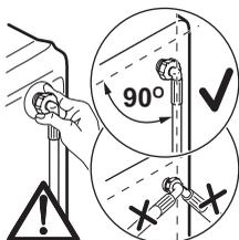
Je-li to nezbytné, přemístíte přívodní hadici ve směru znázorněném na obrázku. Povolte pojistnou matici přívodní hadice a umístěte přívodní hadici dolů, jak je nakresleno na obrázku. Znovu utáhněte pojistnou matici a zkontrolujte, jestli neprosakuje voda.
